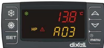
Когда контроллер обнаруживает аварию, в нижней строке отображается код аварии, чередуясь со значением датчика. Загорается иконка аварии ( $\Delta$ ) и мигает.
