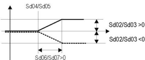
Датчик Pb4 и отрицательный дифференциал:
