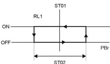
Один компрессор и одна ступень мощности
