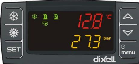
**Верхняя строка (красный цвет):** конфигурируемая параметром CF36 (PB1, PB2, PB4, Уставка (значение параметра)\*, рабочая уставка (реальная уставка, измененная по динамической уставке, функции Энергосбережения или функции для блоков без накопительного водяного бака), Гистерезис, Статус машины\*\*)
