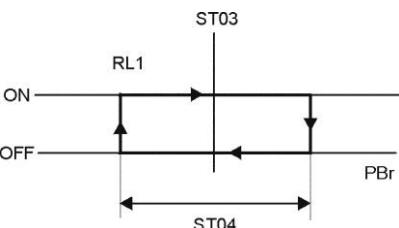
Один компрессор и одна ступень мощности
