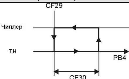
Когда значение температуры находится в пределах диапазона CF30, переключение разрешается только с помощью клавиатуры дисплея.
